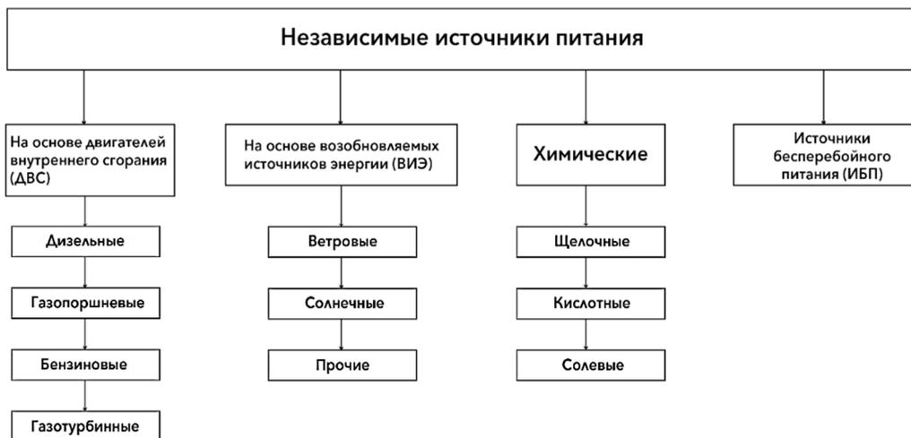
**Рис. 1. Классификация независимых источников питания**
