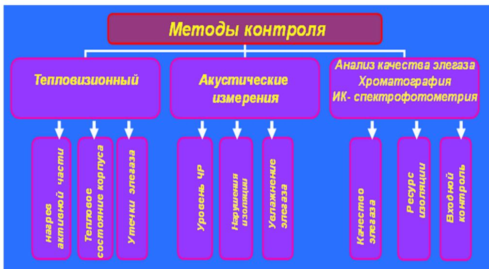
Рис. 9. Основные методы комплексной диагностики измерительных трансформаторов с элегазовой изоляцией
