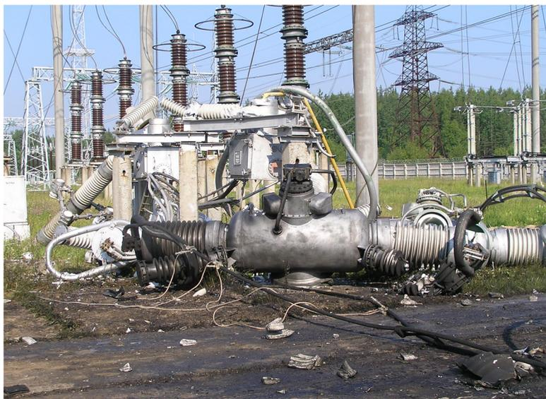
**Рис. 4. Аварийная ситуация с воздушным выключателем на подстанции 750 кВ, разрушение которого произошло из-за тяжения шлейфов от поврежденного взрывом трансформатора тока**
