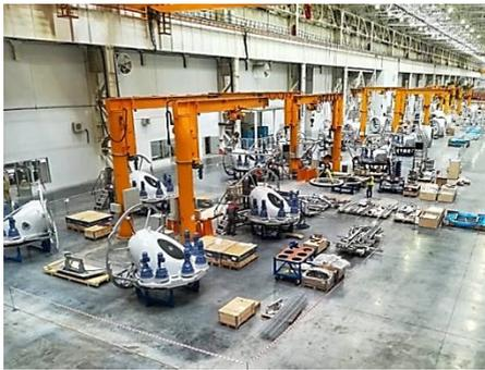
**Рис.12. Производство ступицы ВЭУ**
