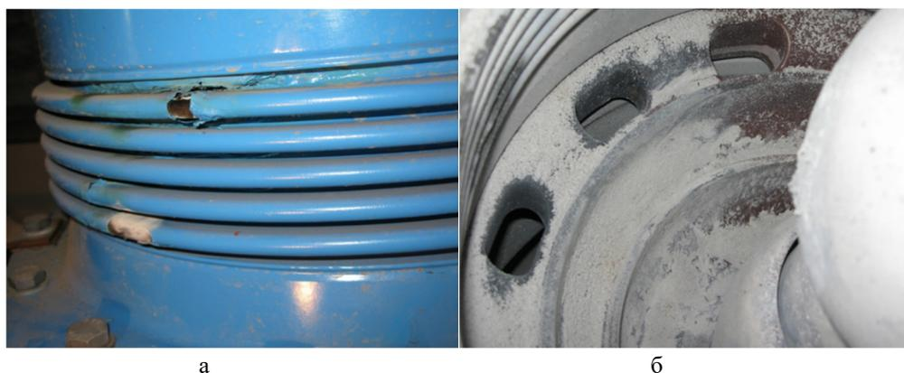
**Рис. 8. Повреждение в токопроводе КРУЭ 500 кВ:**
