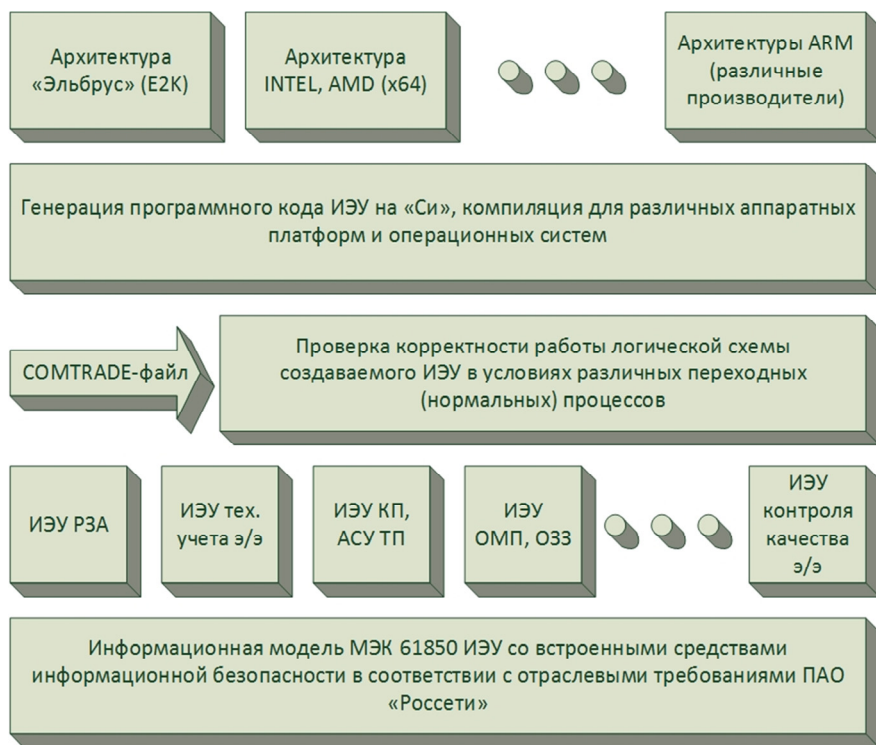
Рис. 3. Процесс создания кроссплатформенного ИЭУ с использованием «Кодогенератора управляющего ПО»
