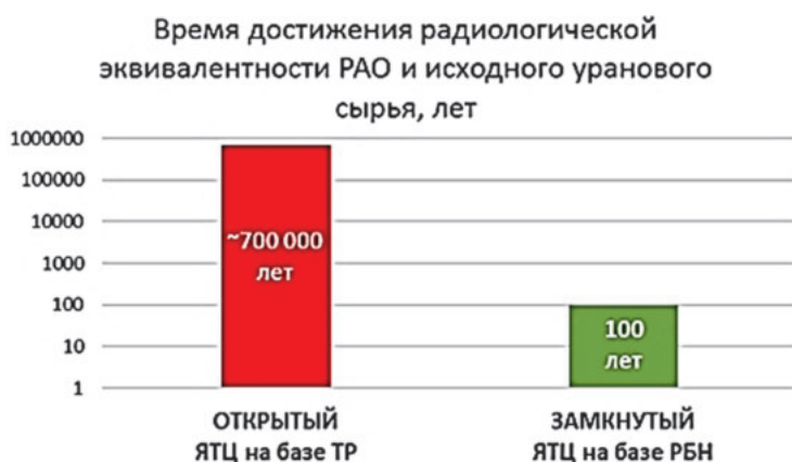
Рис. 2. Время достижения радиологической эквивалентности РАО и исходного уранового сырья для открытого цикла на базе РТН и замкнутого цикла на базе РБН (расчеты АО «Прорыв»)
